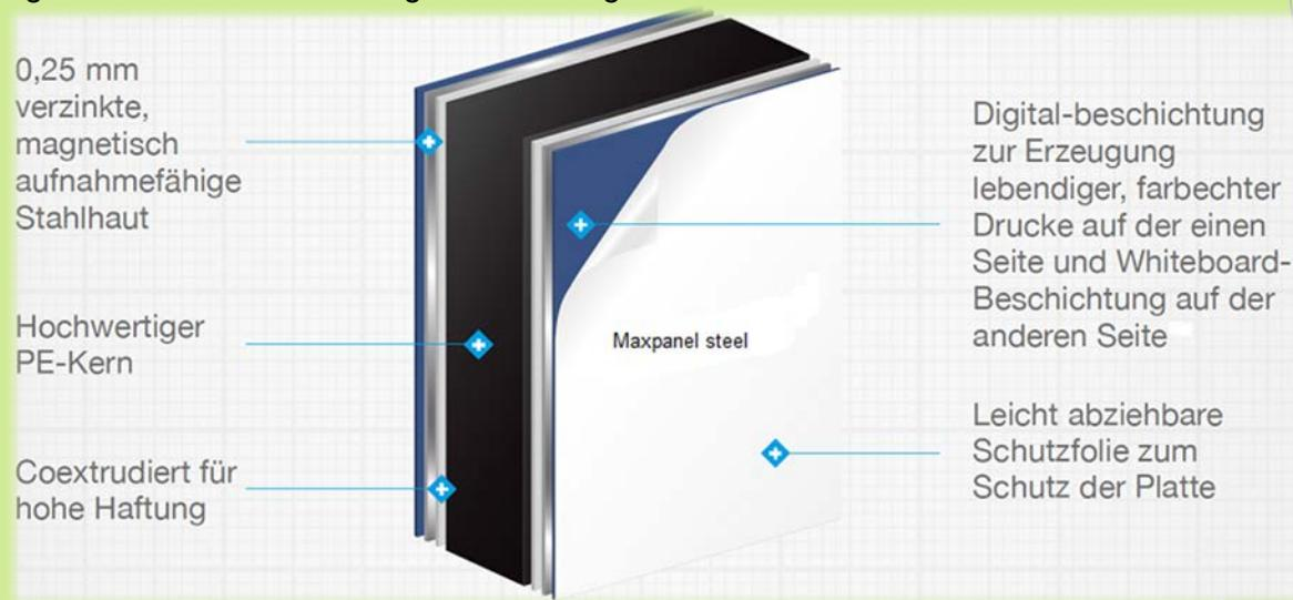
Maxpanel steel ist für Innen- und Außenanwendungen geeignet, aber geschnittene / offene Kanten müssen geschützt werden, um Oxidation bei Freibewitterung zu vermeiden.
